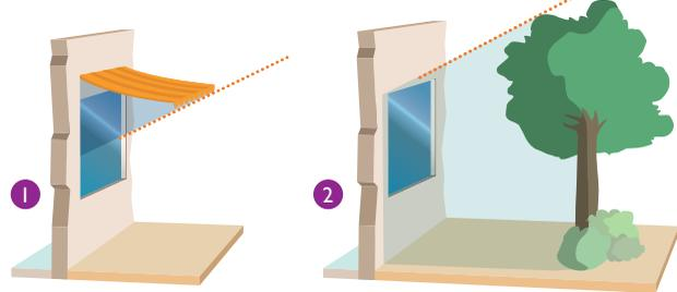
❶ Pour protéger une baie de 2,50 m de haut des rayons du soleil l'après-midi, il faudrait un auvent de plus de 4 m de large. Il est préférable de réduire la hauteur de l'ouverture.
