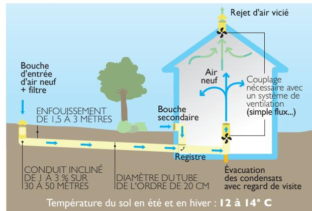
Un conduit souterrain, enterré à 2 m de profondeur environ, amène dans la maison l'air de renouvellement. Celui-ci est rafraîchi par son passage dans le sol, plus frais que l'air extérieur. Ce système permet d'abaisser la température intérieure de quelques degrés.
